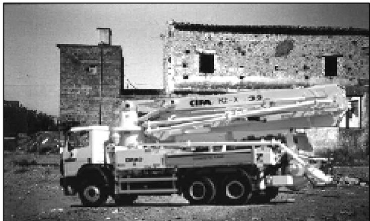
*Foto 1 : Pompa autocarrata con braccio di distribuzione di circa 32 m in verticale*
