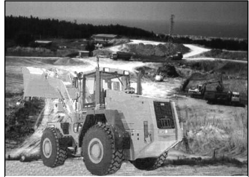
Fig. 2 : Pala gommata marcata CE rispondente ai requisiti del DPR 459/96
