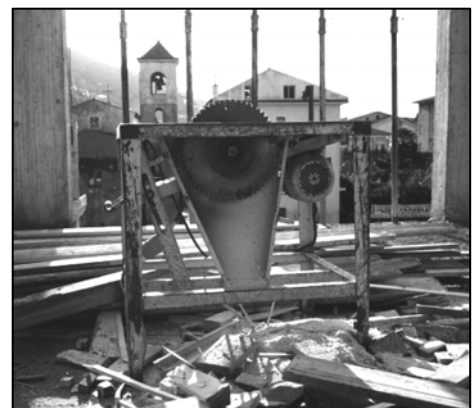
Fig. 3 – Macchina PERICOLOSA Sega circolare priva di:
