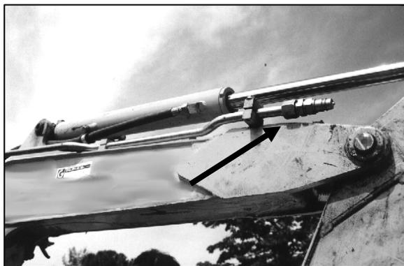
**Foto 4** – Tubazione dx del circuito idraulico indipendente per il funzionamento delle attrezzature opzionali (martello demolitore)
