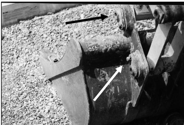
**Foto 6** – Perna priva di spine di sicurezza, per il bloccaggio dell'utensile
